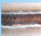
红色在区域2, 黑色在区域1: 保护气体不够, 保护气体的注入时间参数没有正确调整, 气瓶空
