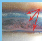
气泡或很多小针孔在区域3: 部件没有正确的清洗, 焊工手脏 (区域3的其他缺陷看下面)
